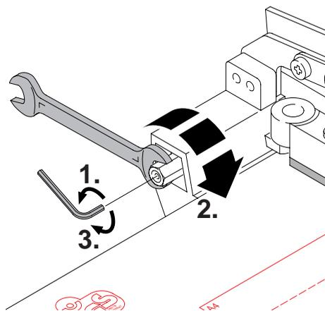
**F** La machine est équipée d'un **frein** sur le levier de coupe, qui l'empêche de s'abaisser de lui-même dans toute position. Si le cas se produisait, le frein doit être réglé de la manière suivante:
