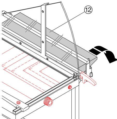
I La carta può essere posizionata anche a filo con la battuta anteriore dotata di dispositivo per rifili millimetrici (8). La manopola graduata (11) consente di determinare con precisione la misura di taglio desiderata, può essere fissata tramite la vite di regolazione per eseguire tagli multipli. I rifili millimetrici (meno di 10 mm) sono possibili grazie allo spostamento automatico della squadra di battuta anteriore durante il taglio.
