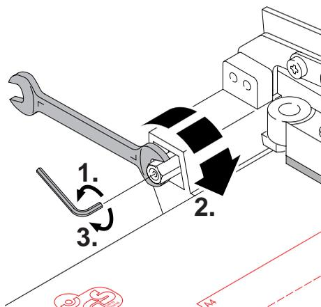
**S** Maskinen har en **justerskruv** i fästet för kniven. Denna gör att kniven stannar i upprest läge, kan justeras enligt nedan.
