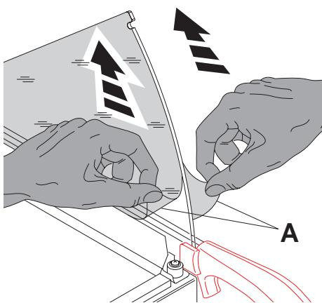
**NL** Voor ingebruikname dient de papieraandruker met de mesbeschermer ① gemonteerd te worden.
