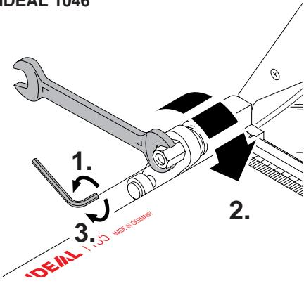
**E** La máquina tiene un **sistema de fricción** en el portacuchillas. Este asegura que el portacuchillas no se pueda mover hacia abajo solo. Si el portacuchillas no está en su posición y se mueve solo, por favor reajustar el sistema de fricción inmediatamente.
