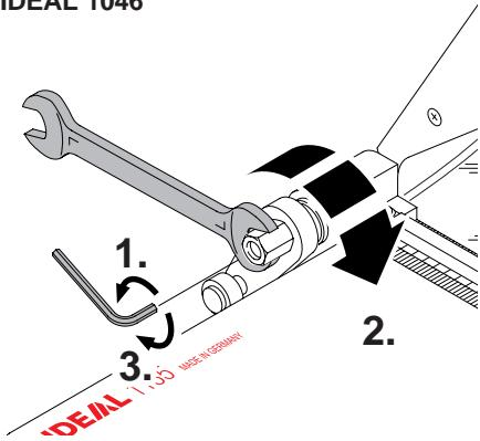
D Die Maschine ist mit einer **Friktionseinrichtung** am Messerhebel ausgerüstet. Sie verhindert, daß der Messerhebel sich aus einer angehobenen Stellung selbstständig nach unten bewegt. Ist dies dennoch der Fall, so muß die Friktionseinrichtung wie folgt nachjustiert werden:
