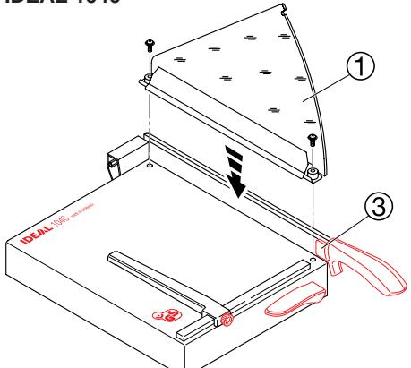
**D** Vor Inbetriebnahme muß die Preßvorrichtung mit dem daran befestigten Messerschutz ① montiert werden.
