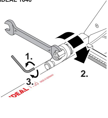
**NL** De machine is uitgerust met een **frictievoorziening** aan de meshouder. Deze zorgt ervoor dat de meshouder niet uit zichzelf neerwaarts beweegt. Indien dit toch het geval is, dan dient de frictievoorziening als volgt te worden nagesteld:
