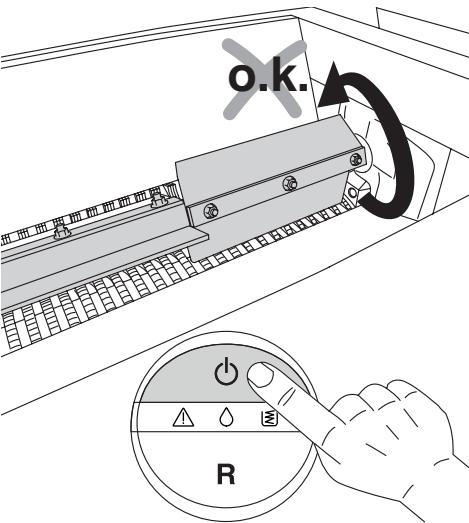
**DE Dreht die Flügelwelle in die falsche Richtung → Drehfeld von einer Elektrofachkraft ändern lassen.**
