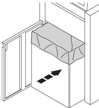
**DE** Beiliegenden Plastiksack in Spänewagen einsetzen.
